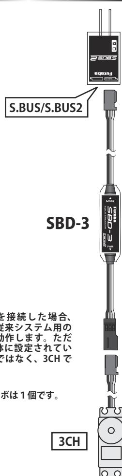
\* S.BUS サーボを接続した場合、そのサーボは従来システム用のサーボとして動作します。ただし、サーボ自体に設定されていたチャンネルではなく、3CH で動作します。
